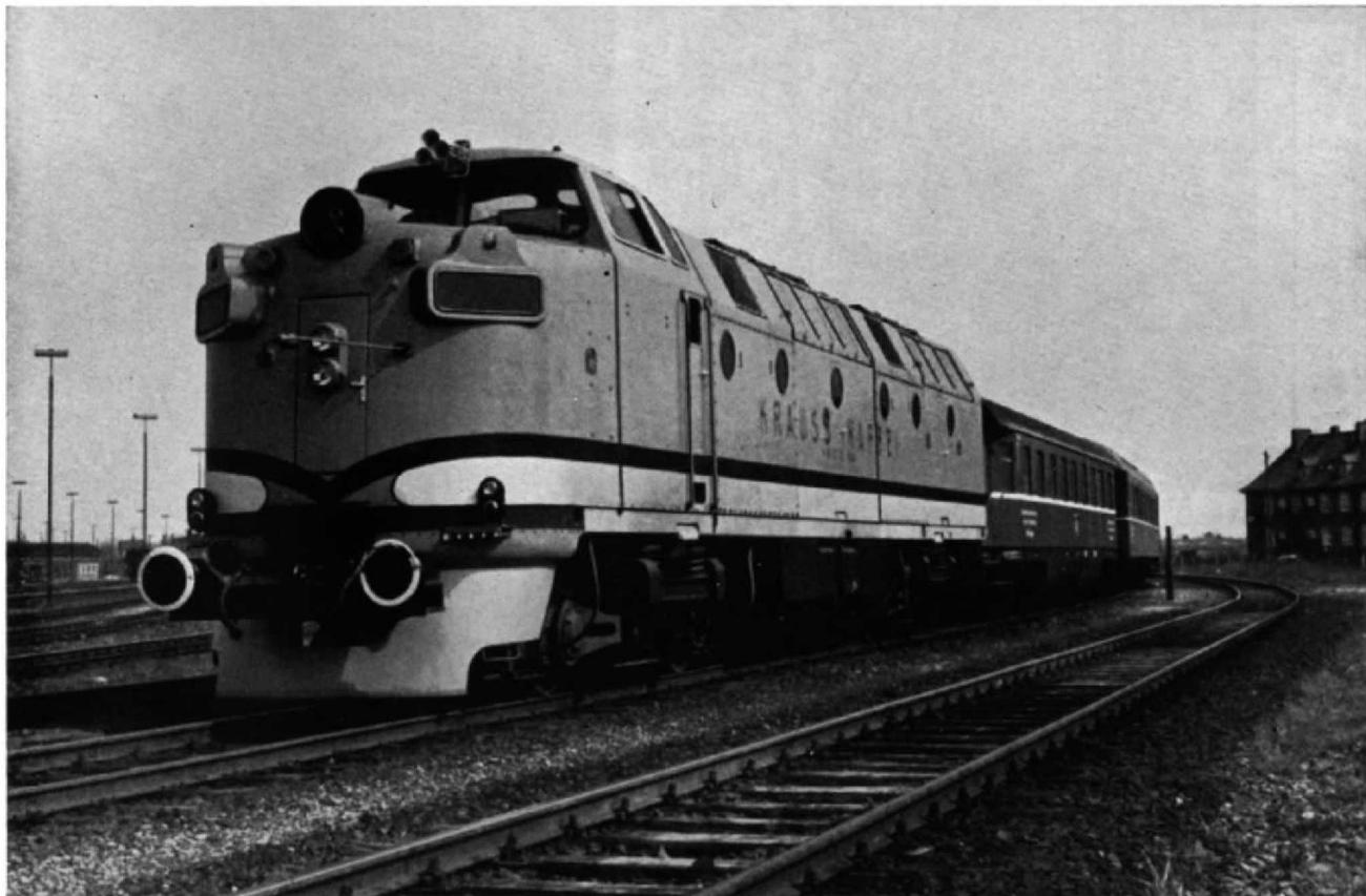
Abb. 1. Eine ML4000 – mit Puffern und Pufferbohle – auf einer Versuchsfahrt in Deutschland. Die Einwärtsneigung der oberen Seitenwandpartien ist als eine Konzession an die engeren Lichtraumprofile der europäischen Strecken zu werten, auf denen ja zunächst die einleitende Erprobung vorzunehmen war. Trotzdem sind hier die sonst üblichen Umgrenzungsmaße bereits überschritten. – Der kleinste befahrbare Krümmungshalbmesser beträgt übrigens nur 76 Meter! (Sämtliche Fotos: KRAUSS-MAFFEI)
