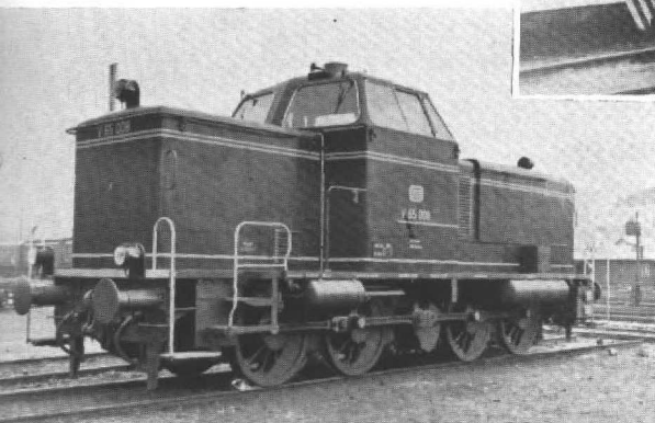
Abb. 15. Die V 65 (3. Stelle) ist der V 60 leistungsgleich, jedoch für max. 80 km/h ausgelegt und daher 4-achsig. Sie ist für den Nebenbahndienst gedacht und weist infolgedessen einen Heizkessel auf, wodurch sie etwas „fülliger“ im Aussehen geraten ist.
