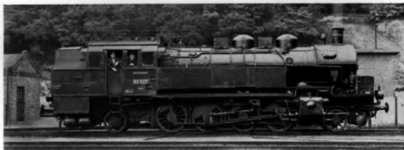
Abb. 6. Die Güterzugtenderlok 93 527 mit der Achsfolge 1'D1', doch wäre u. E. . . .
