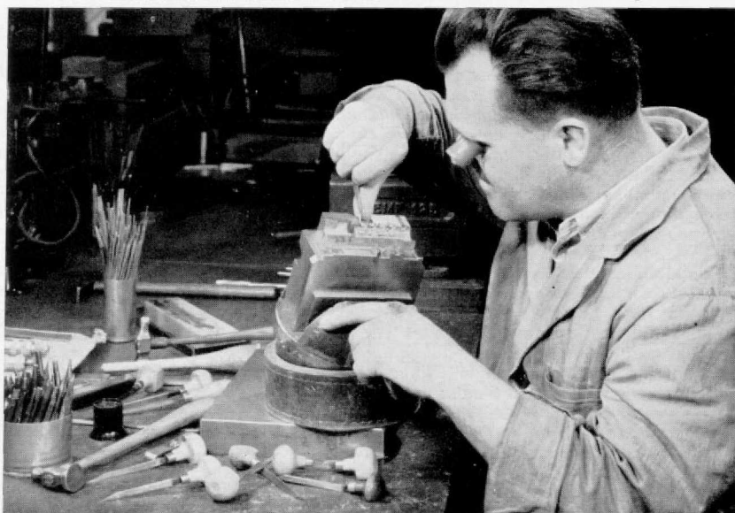
Abb. 18. Die Erstellung einer Spritzform erfordert das ganze Können eines tüchtigen Graveurs!
