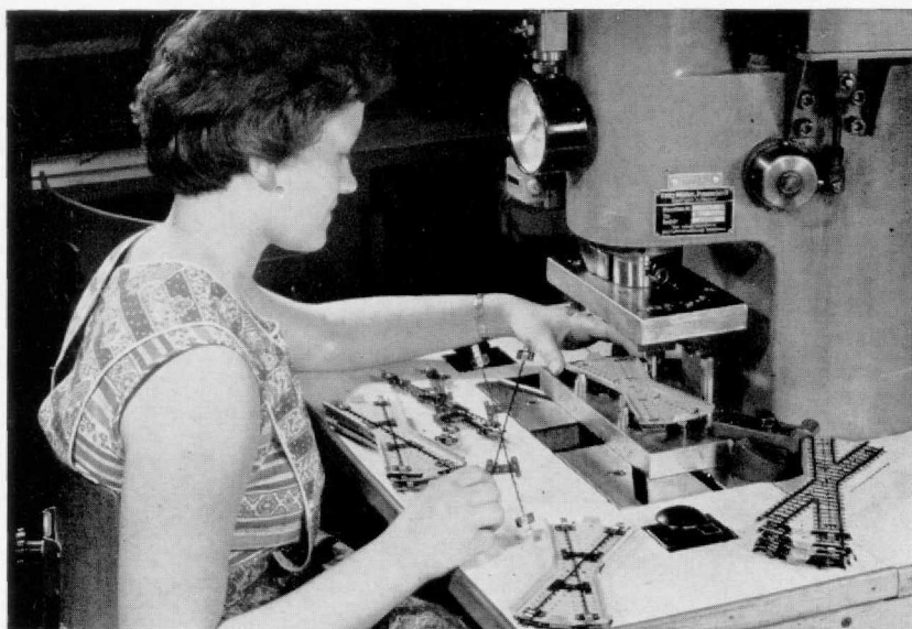
Abb. 17. Ein Blick „hinter die Kulissen“: So wird mit Hilfe einer ölhydraulischen Presse der Punktkontakt-Mittelstrang in eine Kreuzung eingepreßt. Daß die nette Arbeiterin dabei auf ihre nicht weniger netten Finger aufpassen muß, versteht sich für sie und uns als selbstverständlich!
