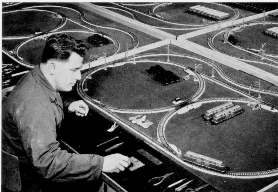
Abb. 19. Bevor eine Lok das Werk mit dem bekannten runden Prüfeticket verläßt, wird sie erst auf einer Prüfstrecke auf Herz und Nieren geprüft.
