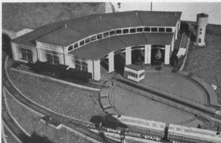
Abb. 93. Die Oberflur-Drehscheibe von 40 cm Durchmesser für 10 Anschlußgleise.
