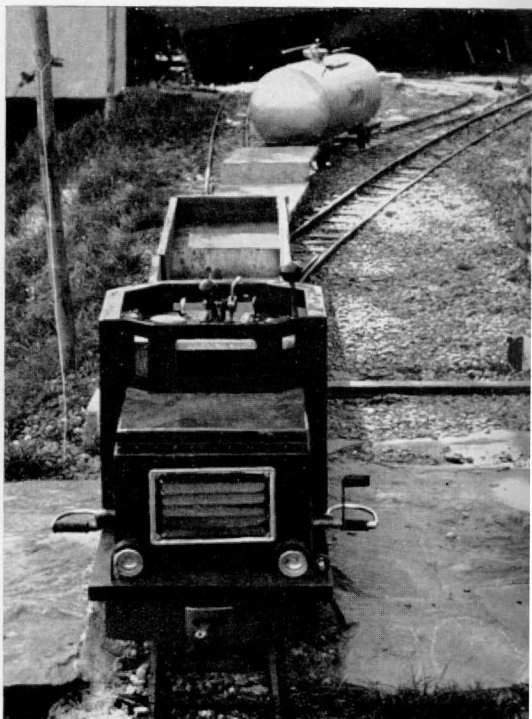
Abb. 3. Fußrasten an der Lok und Griffe und Hebel unter dem Führerhausdach = „Steigbügel“ und „Zügel“ des „reitenden“ Lokführers.
