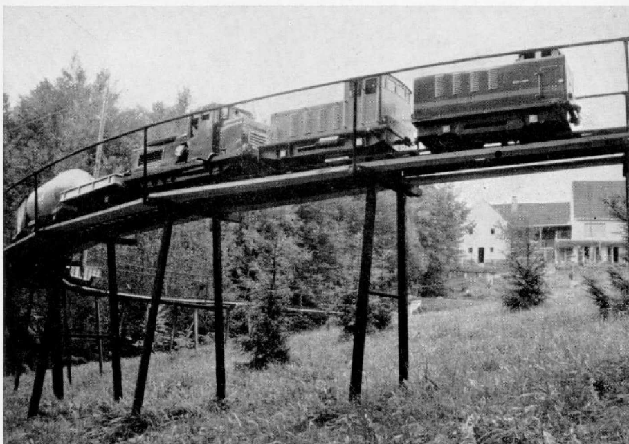
Abb. 5. Die große Bogenbrücke mit den z. Z. fertigen Pseudo-„Diesel“-Loks. „Pseudo“ deshalb, weil als Antrieb für die älteste Dieselloktype z. B. ein 1,5 PS Mopedmotor (mit angebaute Autogetriebe) dient. Als Nachfolger entsteht z. Z. eine 4achsige Lok mit einem 10 PS-Sachsmotor (zur Beförderung schwerster Züge bergauf). Die 2. Loktype entspricht einer Type der Klöckner-Humboldt-Deutz-Motorenfabrik. Der spezielle Elektromotor wird von einer kräftigen Autobatterie gespeist und ist – wie Abb. 4 beweist – sehr leistungsstark. Die vorderste Lok ist eine Weiterentwicklung der vorherigen 12 V-Lok, läuft mit 24 V-Motor und hat eine Steuerung über Schütze, die es gestattet, mehrere Loks hintereinander von einem Führerstand aus zu steuern.
