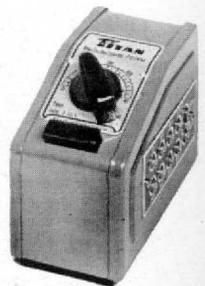
benheiten — eine größere Anzahl von Fahrgeräten, sodaß ab dem 2. Fahrgerät eine wesentliche Verbilligung in der Anschaffung in Erscheinung tritt. Daß dieser Trafo außer einem Primär-Kurzschlußschalter auch noch 2 Sekundär-Kurzschlußschalter (bei 10 und 14 V) besitzt, versteht sich fast am Rande!
