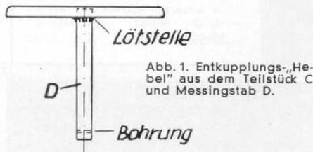
Abb. 1. Entkopplungs-„Hebel“ aus dem Teilstück C und Messingstab D.
