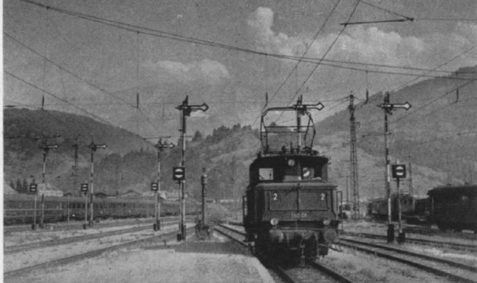
Abb. 1. Ein Wald von bayer. Signalen in Bf. Garmisch, jedoch nur als normale Hauptsignale verwendet und durch Rangiersignale ergänzt. Anstrich der nichtdurchbrochenen Flügel wie auf Seite 9 angegeben. (Foto Bellingrodt)
