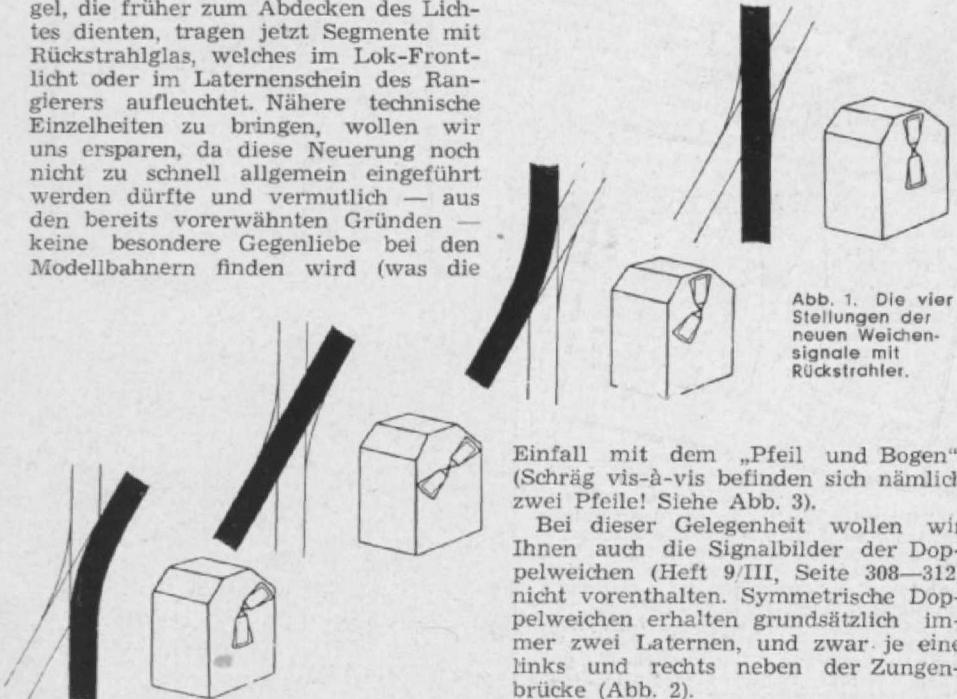
Abb. 1. Die vier Stellungen der neuen Weichensignale mit Rückstrahler.
