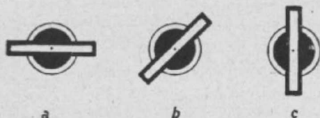
Abb. 2 Die verschiedenen Signalbilder a = Halten — Abdrücken verboten (Ra 6) b = Langsam abdrücken (Ra 7) c = Mäßig schnell abdrücken (Ra 8)
