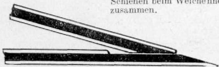
Abb. 2 So paßt Herr Chromek die Schienen beim Weichenherz zusammen.
