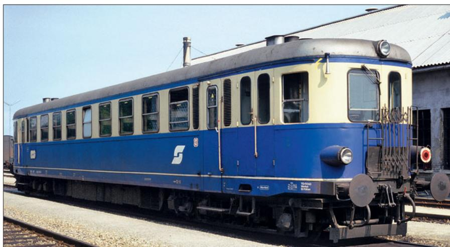
**40** Als VT 42 im Jahre 1935 in Dienst gestellt, wurden die 110 km/h schnellen Triebwagen vorwiegend im nicht elektrifizierten Schienennetz der Österreichischen Bundesbahnen eingesetzt. Bis zu ihrer Ausmusterung 1989 konnte die Konstruktion mit der Achsanordnung (1A)(A1) auf ein recht bewegtes Triebfahrzeugleben zurückblicken – Manfred Peter porträtiert. Foto: Christoph Kirchner
