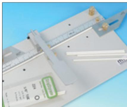
**72** Gutes Werkzeug ist eine solide Basis für so manche Bastelei. Mit scharfer Klinge lassen sich Kunststoffprofile und Holzleisten exakt ablängen. Lutz Kuhl stellt den Modellbau-Schneideprofi von rm vor. Foto: lk
