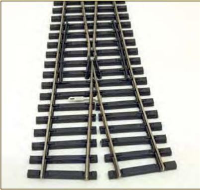
Die Schwellen hinter dem Herzstück werden aufgetrennt und verkürzt.
