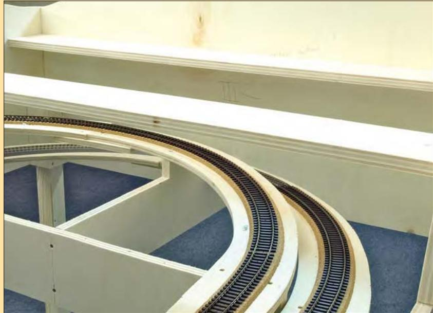
Für die die Landschaftsgrundlage bildenden Hartschaumplatten werden zunächst sogenannte „Tische“ eingebaut, die im Gleisbereich genügend Eingriffsraum im Tunnel bieten. Die schmalen Sperrholzbretter fungieren dann als auf einer Höhe befindliche Auflageflächen für das nachfolgende Geländebaumaterial.
