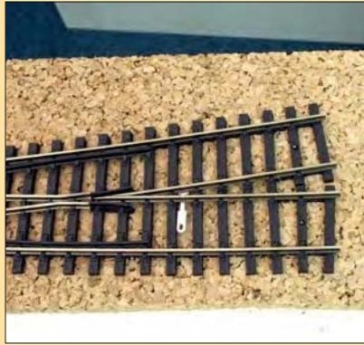
Das gerade verlaufende Gleis wird an das abzweigende Gleis herangedrückt. Dies bewirkt, dass der Bogen des folgenden Gleises bereits etwas vorher beginnt.
