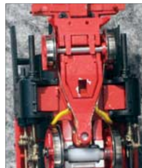
Zwei zusätzliche Stromabnehmerpunkte schuf W. Brauers an seiner Roco-52.
