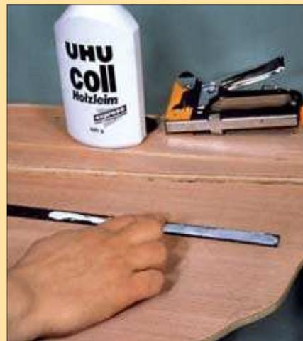
Die diversen Korkbettungen (für die Streckengleise und für das Erzwäschemodul) erhielten einen dünnen Weißleimauftrag, der praktischerweise gleich mit dem Finger verstrichen wurde.
