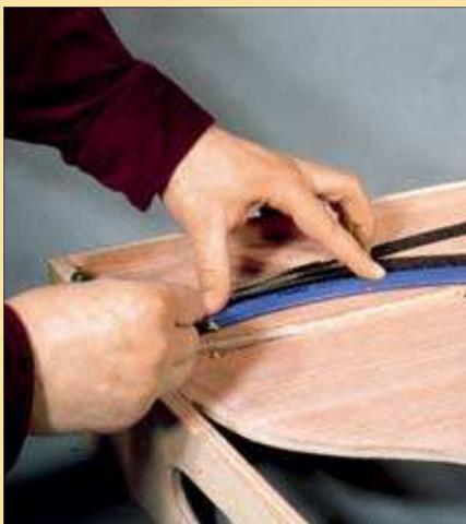
Beim Verlegen der Weichen und dem Aufkleben der Korkbettungen wurde der gefällige, mittige Verlauf mit einem biegsamen Kurvenlineal – bei größeren Bögen mit einer dünnen Holzleiste – aufgezeichnet.
