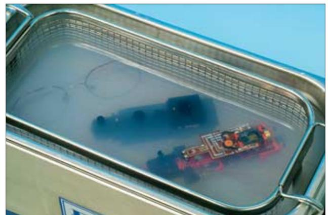
**32** Mit einem Ultraschallgerät lassen sich z.B. Brillen, aber eben auch Modellbahnfahrzeuge mit der gebotenen Vorsicht reinigen. Lutz Kuhl hat das Gerät ausprobiert.
