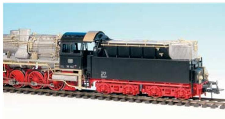
**80** 50 4011 war bei der Bundesbahn die Lok mit dem besten Wirkungsgrad. Die Kombination aus Franco-Crosti-Kessel und Ölfeuerung machte es möglich. Martin Knaden skizziert die Vorbildgeschichte des Einzelgängers und beschreibt den Zusammenbau des Weinert-Bausatzes auf Basis der Roco-50.
