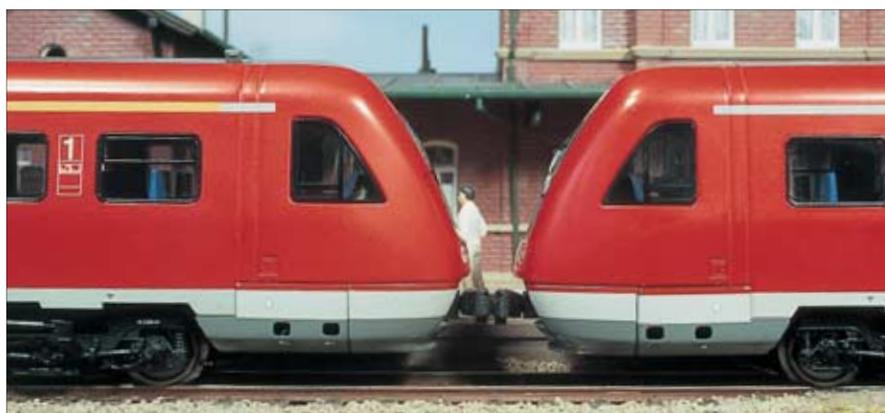
**24** Viele moderne Triebwagen haben beim Vorbild einheitliche Kupplungen der Bauart Scharfenberg, damit sie ohne betriebliche Verzögerungen zu mehrteiligen Einheiten zusammengesetzt werden können. Leider hat sich die Modellbahnindustrie bisher nicht zu einer einheitlichen Modell-Scharfenberg-Kupplung entschließen können, sodass Sebastian Koch „einstweilen“ einen Vorschlag macht, wie man dennoch diese Fahrzeuge vorbildgerecht (also ohne Hilfsdeichsel) kuppeln kann. *Foto: Sebastian Koch*
