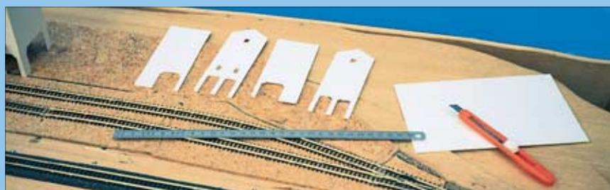
**Entsprechend der zunächst gefertigten Pappmodelle entstanden die eigentlichen Gebäude aus Plastikplatten von Preiser. Im Zechenhaus wurde auch die Transportvorrichtung der Seilbahn nachgebildet (rechts die Gleisseite, links die rückwärtige Front). Beim Zusammenkleben halfen Gummis die Teile zusammenzuhalten.**
