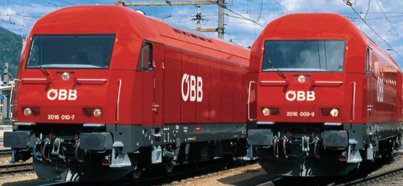
Die dieselelektrische Lokomotive der Baureihe 2016
