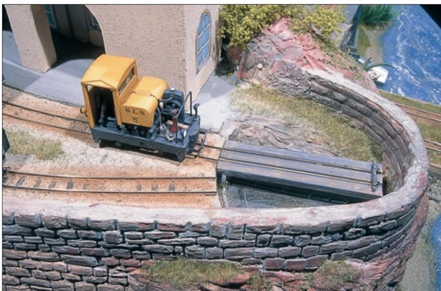
„Berthold“ war in seiner früheren Daseinsform ein schlichtes Auto (BMW-Dixi), bis er auf ein Lokfahrgestell (Roco-H0e) gesetzt wurde. „Ludwig“ hat als Vorbild eine englische Simplex-Diesellok (Wrightlines-Kit) und wird von einem Arnold-Wismarbus-Fahrgestell angetrieben.
