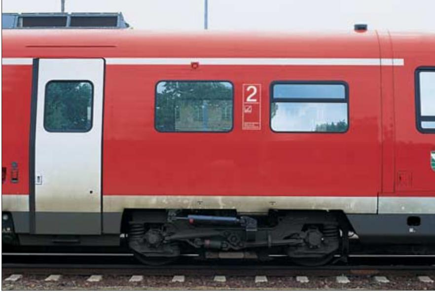
Ein Drehgestell des 612. Deutlich ist hier die Ansteuerung der Neigetechnik zu sehen. Die kleinen Fenster sind typisch für die Neigetechnik-Triebwagen.
