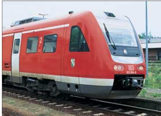
fluss wird über Voith-Strömungsgetriebe erreicht. Motor und Getriebe, Getriebe und Antriebsdrehgestell und beide Radsatzgetriebe sind durch Gelenkwellen miteinander verbunden. Die in jedem Wagen angeordneten Drehstrom-Generatoren (400 V, 50 Hz) speisen die unterschiedlichen Bordnetze von 400 V, 230 V und 24 V.
