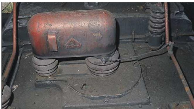
**Bei der E 44 mit Widerstandsbremse waren die Abluftschächte wegen der Pantographengelenke unsymmetrisch geformt.**
