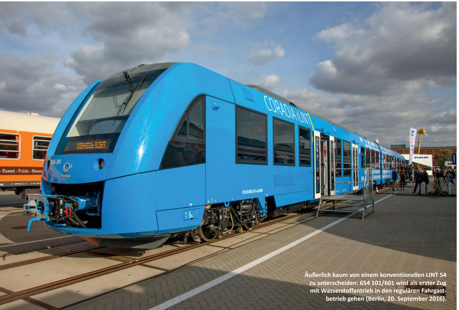
Äußerlich kaum von einem konventionellen LINT 54 zu unterscheiden: 654 101/601 wird als erster Zug mit Wasserstoffantrieb in den regulären Fahrgastbetrieb gehen (Berlin, 20. September 2016).
