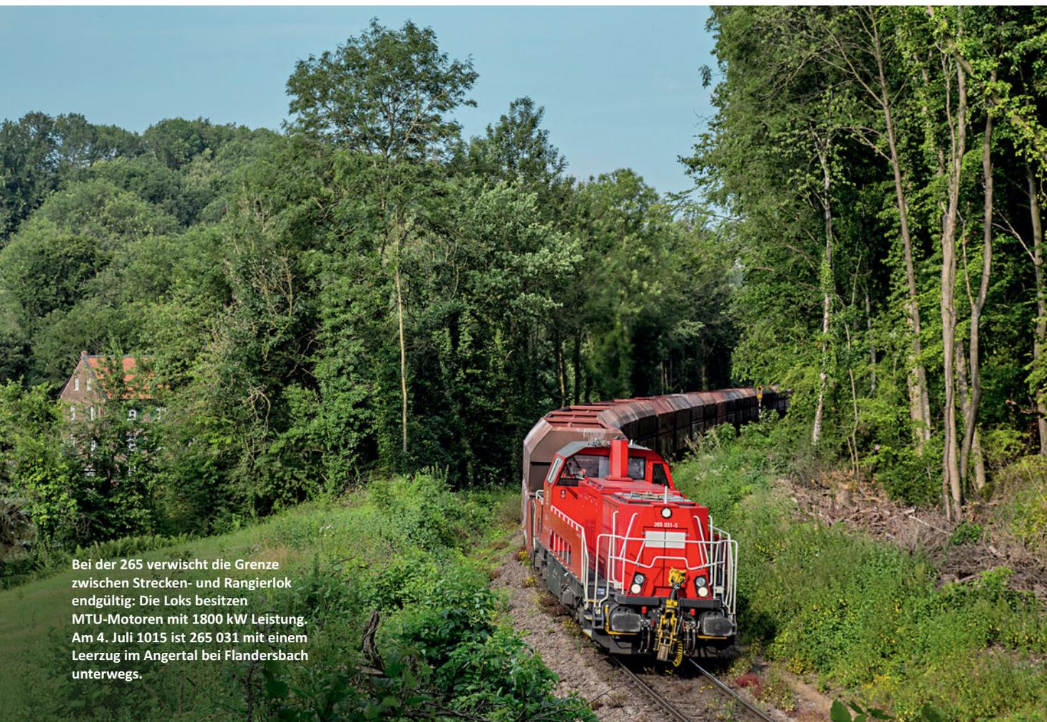
Bei der 265 vermischt die Grenze zwischen Strecken- und Rangierlok endgültig: Die Loks besitzen MTU-Motoren mit 1800 kW Leistung. Am 4. Juli 2015 ist 265 031 mit einem Leerzug im Angertal bei Flandersbach unterwegs.
