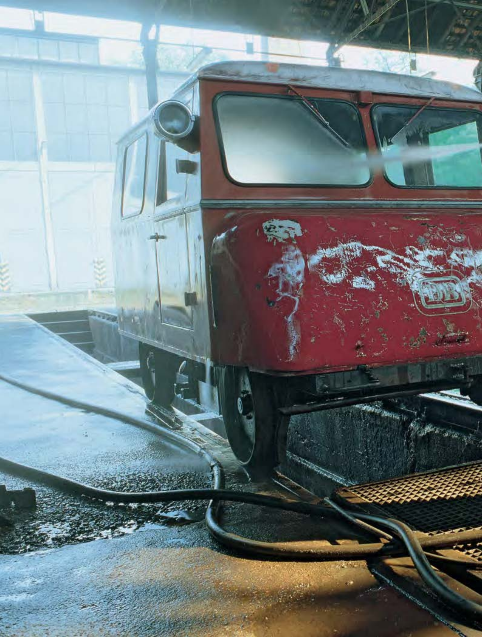
BRENNKRAFT MIT KALTDUSCHE Auch die Kleinen müssen mal in die Wäsche, insbesondere dann, wenn sie gerade noch vor dem Schneidbrenner gerettet worden sind. Der KlV 12-4907 beherbergt einen 28 PS starken VW-Industriemotor und wurde 1960 von der Firma Beilhack an die DB übergeben. Das 1,5 Tonnen schwere Fahrzeug
