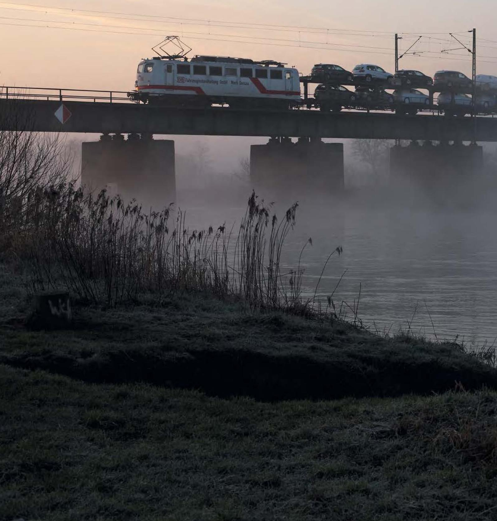
**SCHILLERNDE „ALTE“** Ursprünglich war die heute mit auffälligem Outfit in weiß mit roten Zierstreifen und der Aufschrift „DB Fahrzeuginstandhaltung GmbH Werk Dessau“ versehene 110 511 im Jahr 1959 als E 40 1134 mit Widerstandsbremse gebaut und 1968 in 139 134 umgezeichnet worden. Als Ersatz für eine
