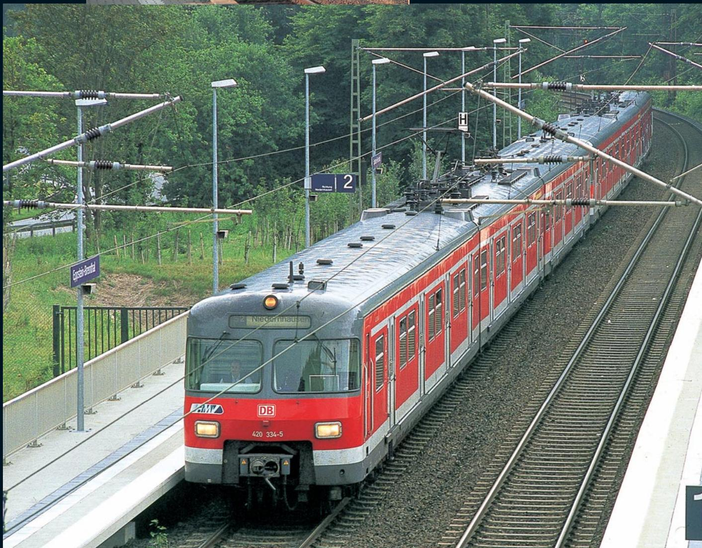
Im Prinzip sind die 420er ganz famose Fahrzeuge. Mit (je nach Bauserie) bis zu 139 t bei 67,4 m Länge sind sie zwar nicht unbedingt superleicht, doch ihr Allachsantrieb mit 12 Fahrmotoren und 2400 kW macht sie spurtstark. Ein S-Bahn-Langzug, aus drei Einheiten gebildet und 202,2 m lang, verfügt über 7200 kW Leistung – fast so viel wie ein etwa gleich langer ICE 3 (8000 kW, 200 m)! Trotzdem liegt seine Höchstgeschwindigkeit nur bei 120 km/h, was im S-Bahn-Verkehr aber ausreichend ist.
