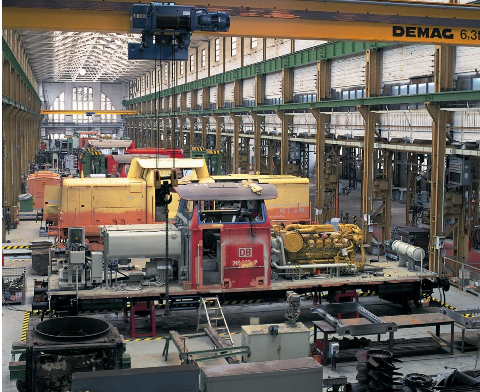
**Der Blick in die Stendaler Werkshalle zeigt V 100 in unterschiedlichen Aufarbeitungs- und Modernisierungsphasen. Im Vordergrund eine ex 213 und 212.**
