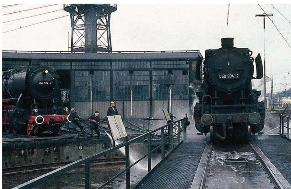
**Chronisten-Pflicht: Entschlacken von 050 904 und Ausspritzen der Drehscheibengrube mit Restdampf von 051 724.**
