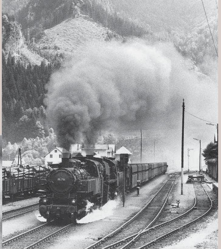
Nicht nur, aber vor allem für die schweren Erzzüge erforderte deren aufwändige Umgehungsroute von Eisenerz über Hieflau durchs Gesäuse nach Selzthal eine zweite Lok vor der 52er – zumeist ein Dienst für die Reihe 86 (oben, Durchfahrt in Hieflau). Der direkte Weg über die Erzbergbahn (links) hatte als Zahnradstrecke nämlich begrenzte Kapazitäten.
