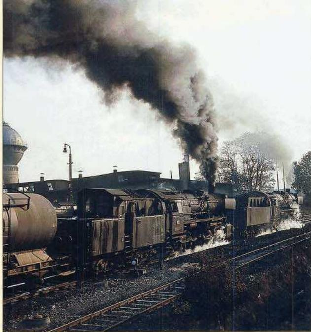
Gekuppelt waren die 23 mit Tendern der Bauart 2'2' T 31, deren Kohlekasten abgestrebte oder glatte Seitenwände aufwies, wie hier beim Tender der 023 027 (großes Bild). Mit langen Güterzügen kamen 44er (oben links) und 50er in Crailsheim an und ergänzten im Bahnbetriebswerk ihre Vorräte.
