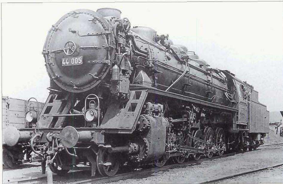
**Baumusterlok 44 005, gebaut von Schwartzkopff 1926, mit hohen Kesselaufbauten nach Umgrenzung II der BO und dem bei den ersten Einheitsloks üblichen Handrad am Vorwärmer zum Umstellen der Durchflussvorrichtung. Abb.: Sammlung Weisbrod**
