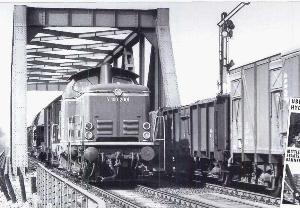
V 100 006 wurde Ende 1959 an den Hersteller MaK zurückgegeben, mit einem 1350-PS-Motor ausgerüstet und dann als V 100 2001 in der BD Münster erprobt – hier aufgenommen im März 1964 auf der Kanalbrücke in Hiltrup.
