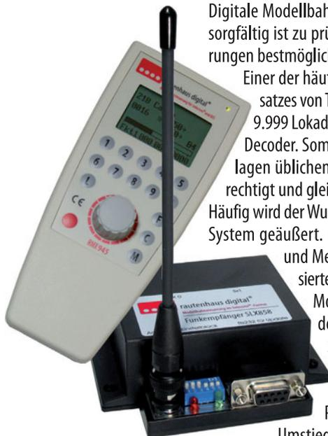
Einer der häufigsten Wünsche ist der des freizügigen Einsatzes von Triebfahrzeugen. Hier bietet das RMX-System 9.999 Lokadressen für **DCC-**, **Selectrix-** und **Selectrix2-**Decoder. Somit können alle auf 2-Leiter-Gleichstrom-Anlagen üblichen Decoder eingesetzt und absolut gleichberechtigt und gleichzeitig betrieben werden.
