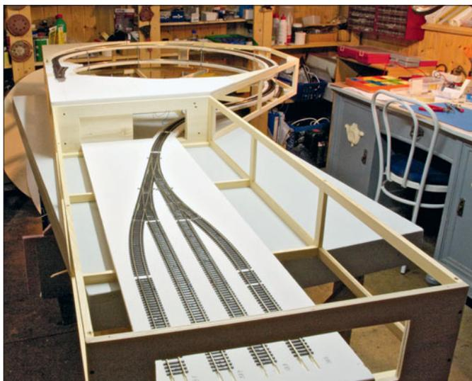
Die Kopfplatten der Segmente bestehen weiterhin aus 10 mm dicken Sperrholzplatten, um ein bündiges Verschrauben der Segmente zu gewährleisten. Um einzelne Segmentkästen aus dem geschlossenen Anlagenverband herausnehmen zu können, führen die Kabelverbindungen über frei hängende Sub-D-Steckverbindungen.
