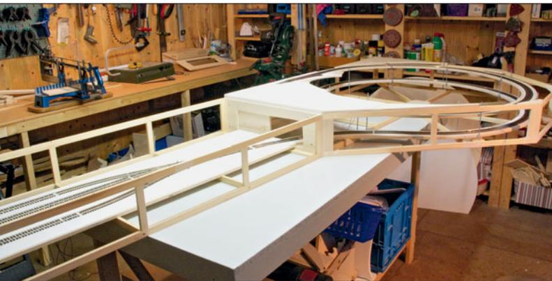
Neue Wege wurden nicht nur bei der digitalen Ausstattung beschriften, sondern auch beim Bau der Rahmen. Statt Sperrholz- bzw. Tischlerplatten entstanden leichte Rahmen aus Glattholzleisten. Diese Bauweise hat sich später durch ihr geringeres Gewicht beim Handling der einzelnen Segmente bezahlt gemacht. Denn diese ließen sich z.B. beim Installieren der Elektrik und der digitalen Komponenten viel leichter drehen und wenden.
