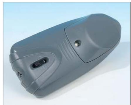
Unter dem Handsender ist der Schiebeschalter zu finden, über den zwischen vier Lokomotiven ausgewählt werden kann.
