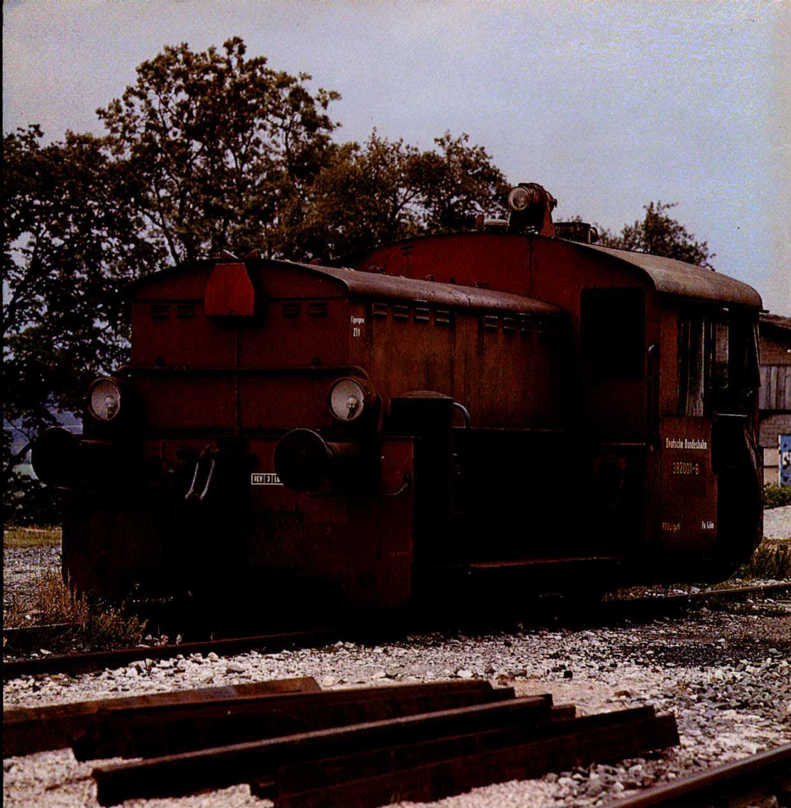
Bild 1: Im Jahr 1955 stellte die DB zwei neue Akkulokomotiven in Dienst, die in ihren Hauptabmessungen der Köf II entsprachen. Die Aufnahme zeigt die Lok 382 001 in Bopfingen.
