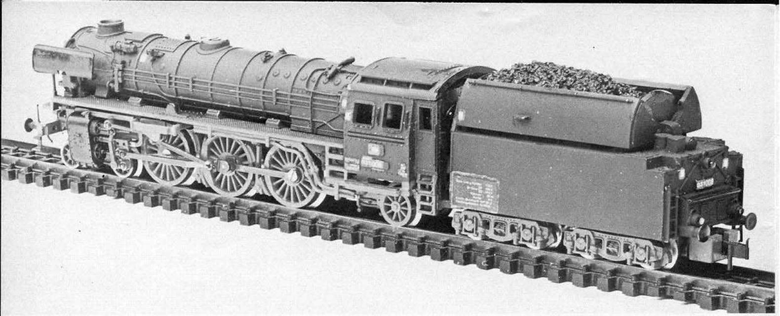
**Bild 1:** Die auffälligsten Merkmale der 03<sup>10</sup> gegenüber der normalen 01 oder normalen 03 sind die Tenderabdeckklappen sowie die Kohlenachsiebehydraulik und die Führerhausverlängerungsteile in Form von geschlossenen Türen. Das Kolbenstangen-Schutzrohr des dritten Zylinders zwischen Rauchkammertüre und Pufferbohle trägt ein übriges dazu bei.
