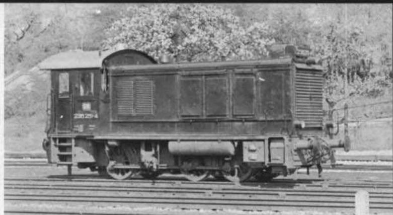
**Bild 5:** Die 236 261 (V 36 also mit Computer-Nummer) ebenfalls in Aalen fotografiert. Diese V 36 ähnelt ebenfalls sehr stark der M+F-Lok in der Ausführung 1, hat jedoch zusätzlich noch einen Vorratsbehälter über den ersten Treibachsen. Dieser Vorratsbehälter kann jederzeit dem M+F-Ergänzungssatz entnommen und zusätzlich angebracht werden. Vor dem Vorratsbehälter ist auch sehr gut der kleine Kokssofen erkennbar. Auch diese Lokomotive stammt aus der Nachkriegsserie von 1947.
