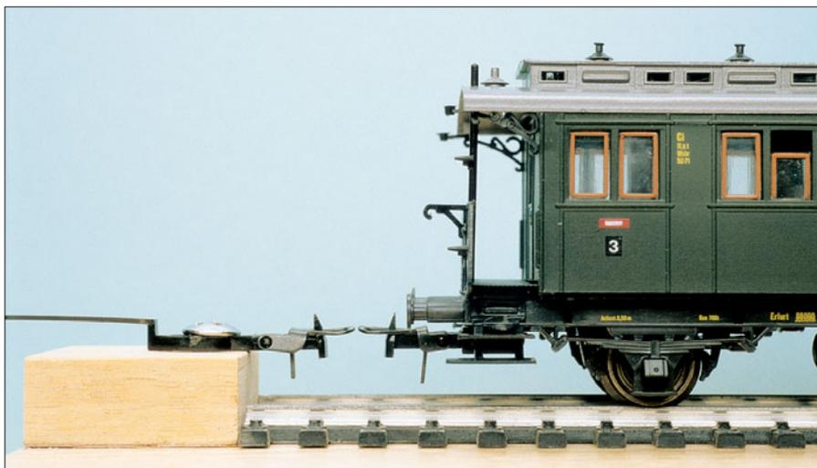
kraft beobachtet werden (Bild 9). Damit Sie die Kupplung nicht mehrere Male aus- und einhängen müssen, rate ich Ihnen, zuerst mit Hilfe eingeschobener Papierstreifen und einer Schiebellehre den Fehlbetrag zu ermitteln.
