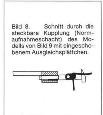
Bild 8. Schnitt durch die steckbare Kupplung (Normaufnahmeschacht) des Modells von Bild 9 mit eingeschoobenem Ausgleichsplättchen.
