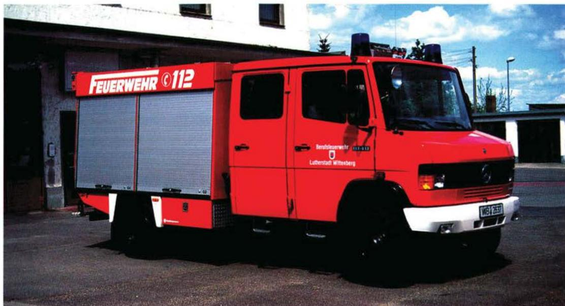
*Abb. 2 Klein(tank)löschfahrzeuge finden seit Mitte der 90er Jahre mehr und mehr Abnehmer, obwohl es dafür keine Norm gibt. Sie sind als Mittelding zwischen TSF-W und LF 8/6 anzusehen. Die BF Lutherstadt Wittenberg beschaffte 1997 diesen Mercedes-Benz 814/37 DA als KTLF 8/8 mit Aufbau von Schlingmann, um ein besonders wendiges, kompaktes Fahrzeug für Kleinsätze zu haben, das die schwierigen Verkehrsverhältnisse besser meistert als z.B. ein TLF 16/25.*
