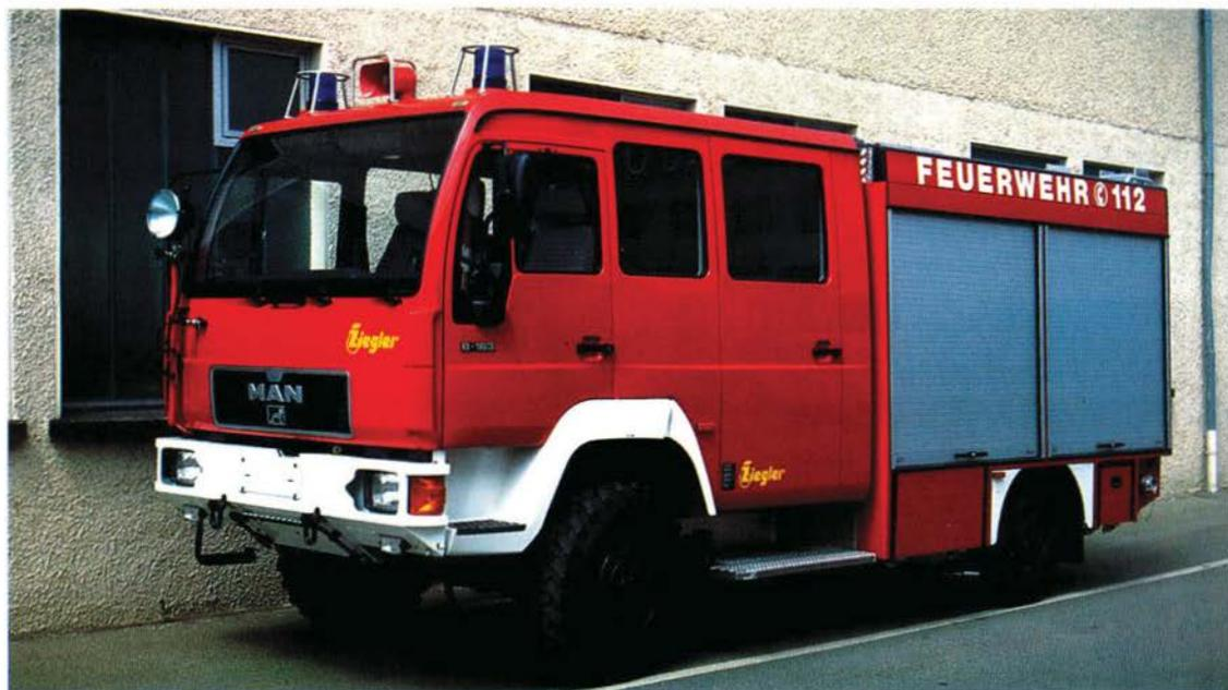
*Abb. 4 Die bei Ziegler gebauten LF 8/6 auf MAN-Allradfahrgerstellern besitzen seit 1997 die Kabine in GFK-Bauweise, die bei der Straßenversion schon seit 1996 verwendet wird. Dieses Fahrzeug (MAN 8.163 FAE) wurde 1997 an die FF Waldfeucht ausgeliefert. Die neue GFK-Kabine wirkt durch die hohe Frontscheibe optisch nicht nur gefälliger, sie bietet auch eine durch Pendelschlagversuche nachgewiesene größere Stabilität gegenüber der Verbundbauweise.*
