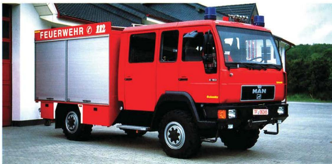
*Abb. 5 Die Wilnsdorfer Firma Schmitz GmbH, vor allem bekannt durch die GW-Gefahrgut, hat ihre Produkt-Palette 1997 auch auf Löschgruppenfahrzeuge ausgedehnt. Diese Fahrzeuge sind in erster Linie für den Markt in den neuen Bundesländern bestimmt. Die Lagerung der Steckleitern erfolgt bei diesem Vorführ-LF 8/6 (MAN 8.163 FAE) im Aufbau, im Heck ist eine Jöhstadt-FP 8/8 (PF Pumpen und Feuerlöschtechnik GmbH, Jöhstadt, früher Flader) eingebaut.*
