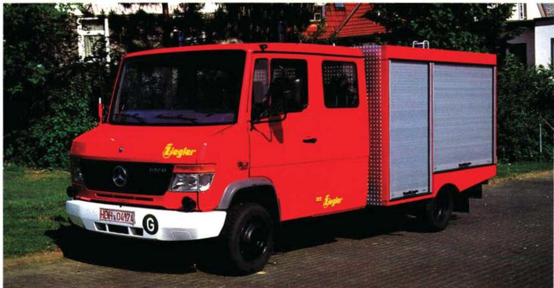
*Abb. 3 Ziegler präsentierte 1997 erstmals sein neuentwickeltes KTLF 8/7 („KTLF plus“ genannt) auf einem Mercedes-Fahrgestell vom Typ 612/37 D. Besonderes Merkmal ist die Kamat-Fogtec-Hochdrucklöschanlage, die neben einer TS 8/8 mitgeführt wird. Beide Pumpen müssen zum Betrieb nicht abgeladen werden, sondern können vom ausgezogenen Schlitten aus betrieben und mit dem 700-l-Tank verbunden werden.*
