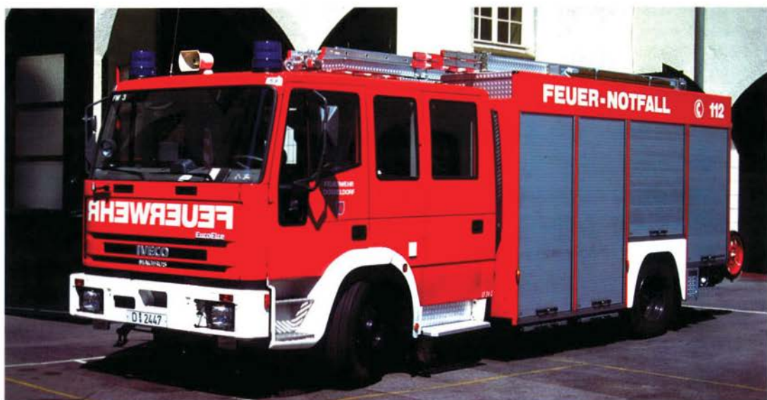
Abb. 5 Zwei von insgesamt sieben neuen LF 24 auf Iveco-Fahrgestellen vom Typ 150E27 wurden 1996 an die BF Düsseldorf ausgeliefert. Die AluFire-Aufbauten, die beidseitig zwei extrem tieferuntergezogene Geräteräume besitzen, fertigte Magirus. Zur Ausrüstung gehören u.a. zwei französische Haspeln, Schleuderketten und Warnblitze am Heck.
