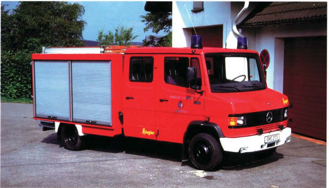
Abb. 1 Die kleinsten Fahrzeuge zur Brandbekämpfung sind die Tragkraftspritzenfahrzeuge TSF und TSF-W, die auch heute noch für Dorffeuern beschafft werden. So erhielt die Löschgruppe Piene der FF Gummersbach 1996 dieses TSF-W mit Ziegler-Aufbau auf einem Mercedes-Benz-Fahrgestell vom Typ 510/37.
