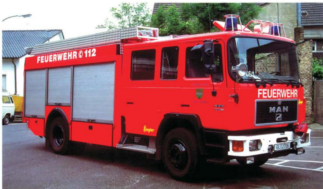
Abb. 4 Auf einem MAN-Fahrgestell vom Typ 18.272 F ließ sich die Feuerwehr Bergisch Gladbach von Ziegler 1996 ein LF 24 aufbauen. Im Gegensatz zu den Nachbarstädten Köln, wo die kurze Bauform bevorzugt wird, und Leverkusen, wo die schmalere Variante (2,3 m breit) favorisiert wird, verzichteten die Gladbacher auf derartige Vorgaben.
