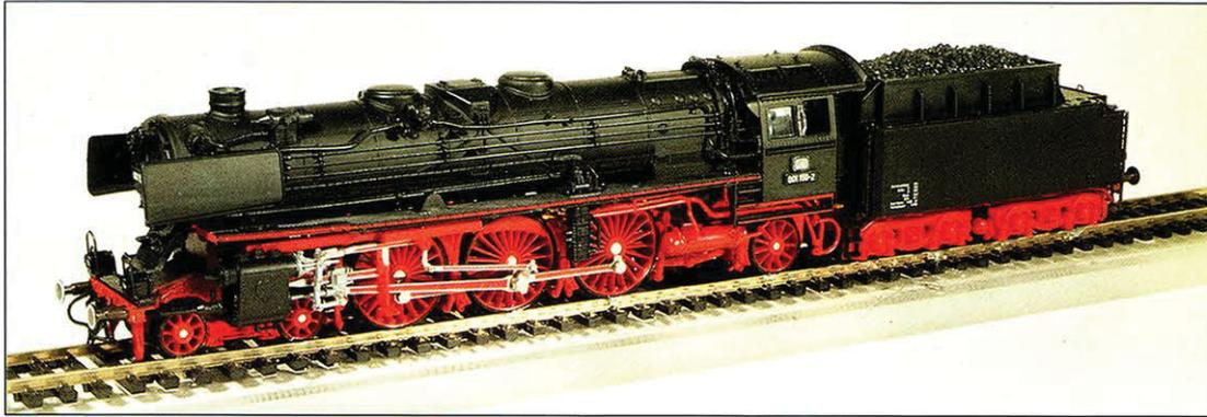
Bild 3. Gut stehen dem Modell die feinen Räder (mit Achszentrierbohrungen und schwarz vernickelten Spurkränzen) „zu Gesicht“.
