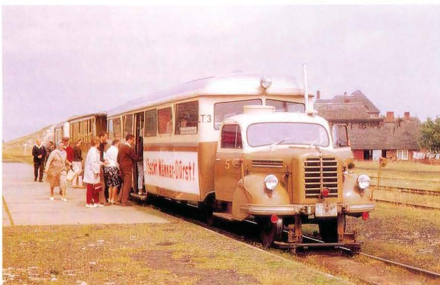
**Bild 4.** Als dieses Bild von Erich Rockelmann um 1963 im Bf List aufgenommen wurde, war die meterspurige Sylter Inselbahn bereits als Straßenbahn umkonzessioniert worden. Die kuriosen, auf Borgward LKW-Basis entstandenen Leichttriebwagen mußten übrigens an den Streckenendpunkten auf einer Drehscheibe gewendet werden.
