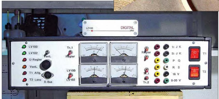
Das Gerät unter der Zentrale beherbergt Stromversorgung und eingebaute Fahrstrombooster.
