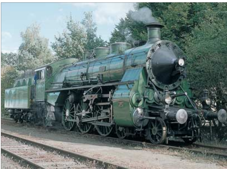
Links: Der süddeutsche Lokomotivbau legte großen Wert auf architektonische Qualität, zu der auch die spitzkeglige Rauchkammertür der S 3/6 gehörte. Fotos: Leikra
