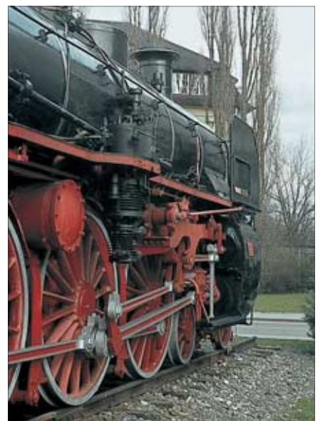
Links: Der süddeutsche Lokomotivbau legte großen Wert auf architektonische Qualität, zu der auch die spitzkeglige Rauchkammertür der S 3/6 gehörte. Fotos: Leikra
