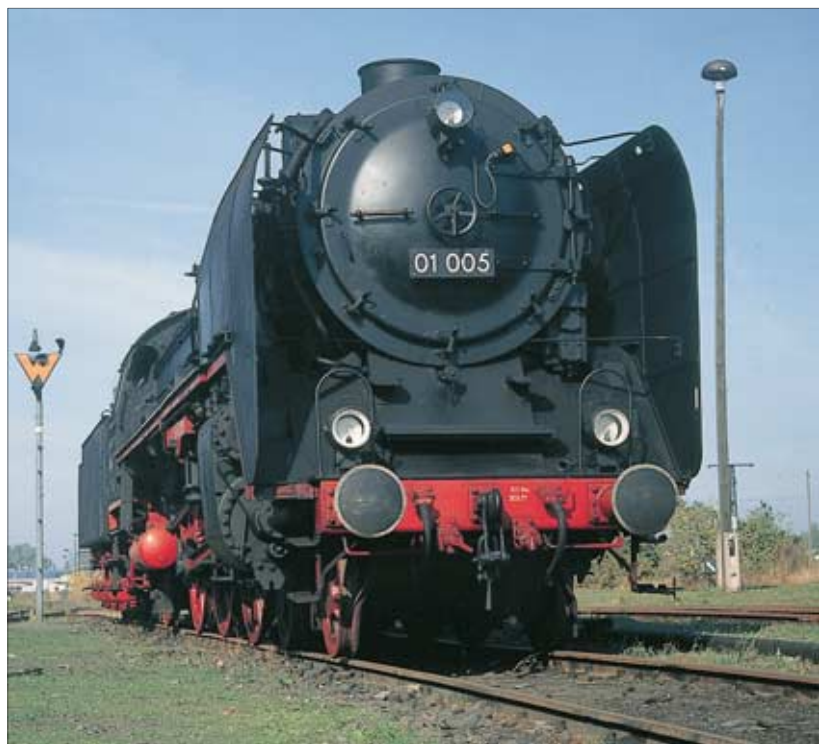
35 Einheitsloks der Baureihe 01.0-2 erhielten von 1962 bis 1965 im damaligen Raw Meiningen eine Rekonstruktion, die ihr Äußeres stark veränderte, wozu vor allem die hohen, steilen Schürzen, die spitzkegelförmige Rauchkammertür und die Witte-Windleitbleche beitrugen.
