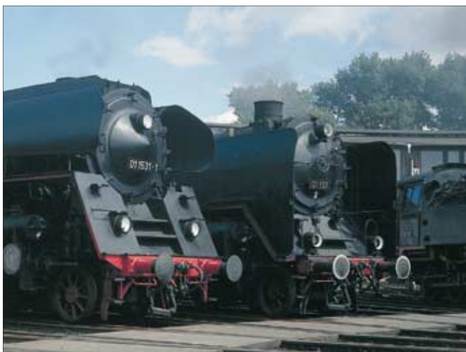
35 Einheitsloks der Baureihe 01.0-2 erhielten von 1962 bis 1965 im damaligen Raw Meiningen eine Rekonstruktion, die ihr Äußeres stark veränderte, wozu vor allem die hohen, steilen Schürzen, die spitzkegelförmige Rauchkammertür und die Witte-Windleitbleche beitrugen.
