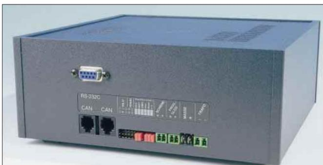
**Die Zimo-Zentrale bietet bis zu drei Datenformate: DCC, MM und Zimo. Nur über den CAN-Bus läßt sich die hohe Funktionalität der Zentrale MX1 ausnutzen.**
